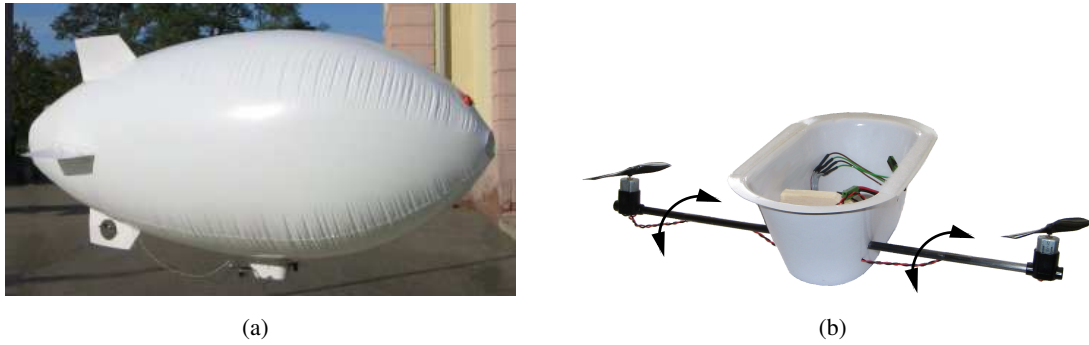
Abbildung 1: (a) Das Luftschiff mit einer Länge von 1,8 m, einem Durchmesser von 0,9 m und einem Gesamtgewicht von 500 g. Die gesamte Hardware ist in der Gondel untergebracht. (b) Die Gondel mit den beiden Motor um Nickwinkel und Schub zu kontrollieren. Die Motoren können dazu um 180 Grad gedreht werden.
