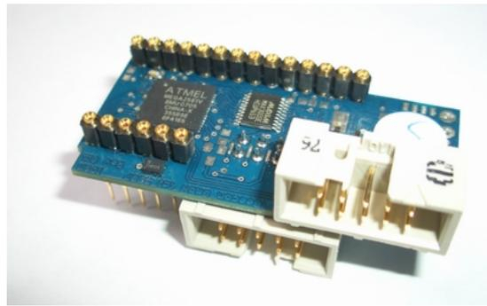
Abbildung 2: Eine Zielplattform von Ambicomp, das Beacon IOSM, basiert auf dem ATmega2561 mit Steckerleisten für das EthernetSM und Sensoren.
